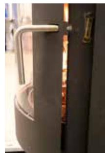
4. Lorsque l'on constate (après 5 à 10 min.) que la cheminée est chaude et qu'il y a du tirage, fermer complètement la porte. Si toutes les conditions sont remplies, après 15 à 20 minutes au plus, une épaisse couche de braises va se former dans la chambre de combustion et la température sera assez élevée dans la chambre de combustion pour que la phase de combustion puisse se dérouler correctement.
