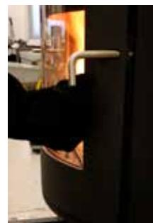
5. Nadat aan de voorwaarde in fase 4 is voldaan, legt u maximaal 2 stukken hout met een totaalgewicht van 2,5 à 3 kg en een lengte van 25 à 35 cm op de gloeiende laag, in één laag, met een onderlinge afstand van ongeveer 1 cm. Vermijd om het hout te dicht tegen de glasplaat van de kachel te platsen. Hierdoor kan roet ontstaan op het glas.
